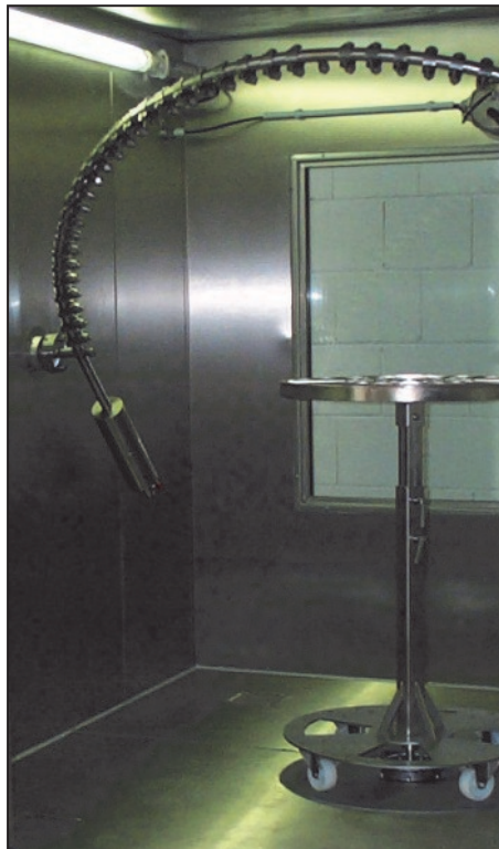
Schwenkbogen R800 montiert in Spritzwasserkammer SPK/R800
