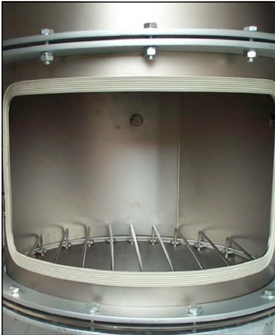
Abbildung 2: Prüfraum der Staubtestkammer mit den 9 einzel herausnehmbaren Auflagebügeln
