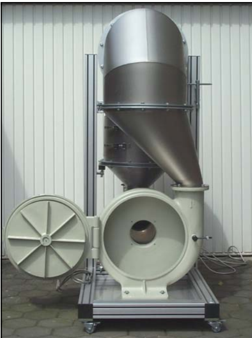
Abbildung 1: Seitenansicht der Staubtestkammer STK 500 mit geöffnetem Spezialgebläse. (Reinigung beim Wechsel des Prüfstaubs)
